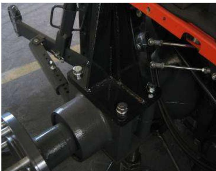
*foto 1a = Fissaggio panca come per roll bar originale.*
