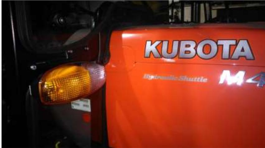
*foto 15a = posizionamento delle frecce anteriori ( fare attenzione che il cristallo parabrezza non urti ne il supporto ne la freccia) COD. TAB. 27 cod.6021060500.*
