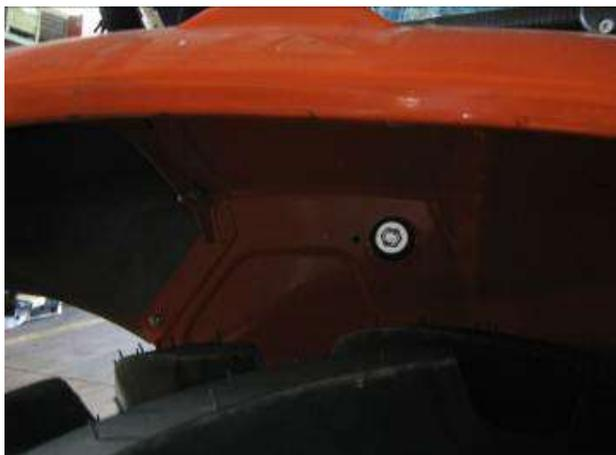
*foto 3° - 3b= fissaggio parafango ( in alto come in basso con viti originali)*
