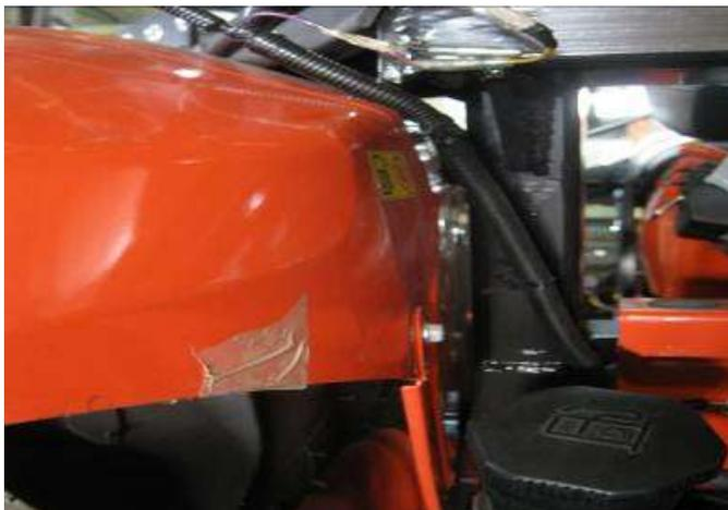
*foto 2a = fessura rimanente tra parafanghi e panca da chiudere con guarnizione adesiva.
