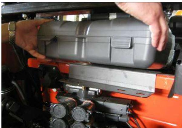
*foto 12b= cassetta attrezzi con staffa di fissaggio
