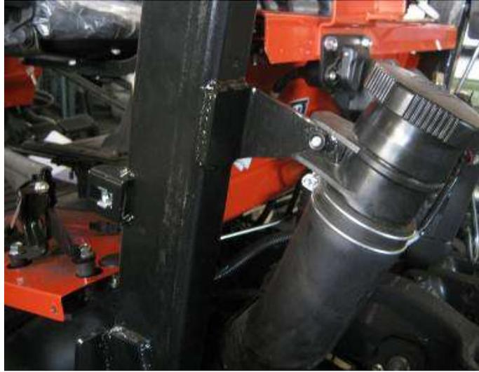
*foto 1b = fissaggio tubo*
