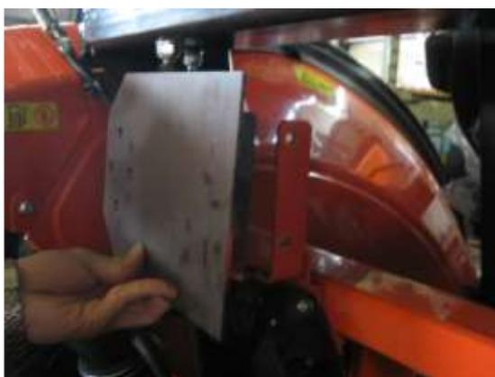
*foto 13a= porta targa da avvitare al supporto esistente, con viti originali e inserendo la luce originale.
