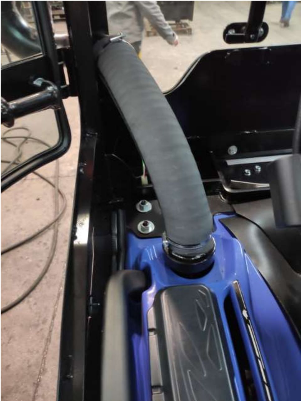
Fissaggio tubo benzina all'interno della cabina
