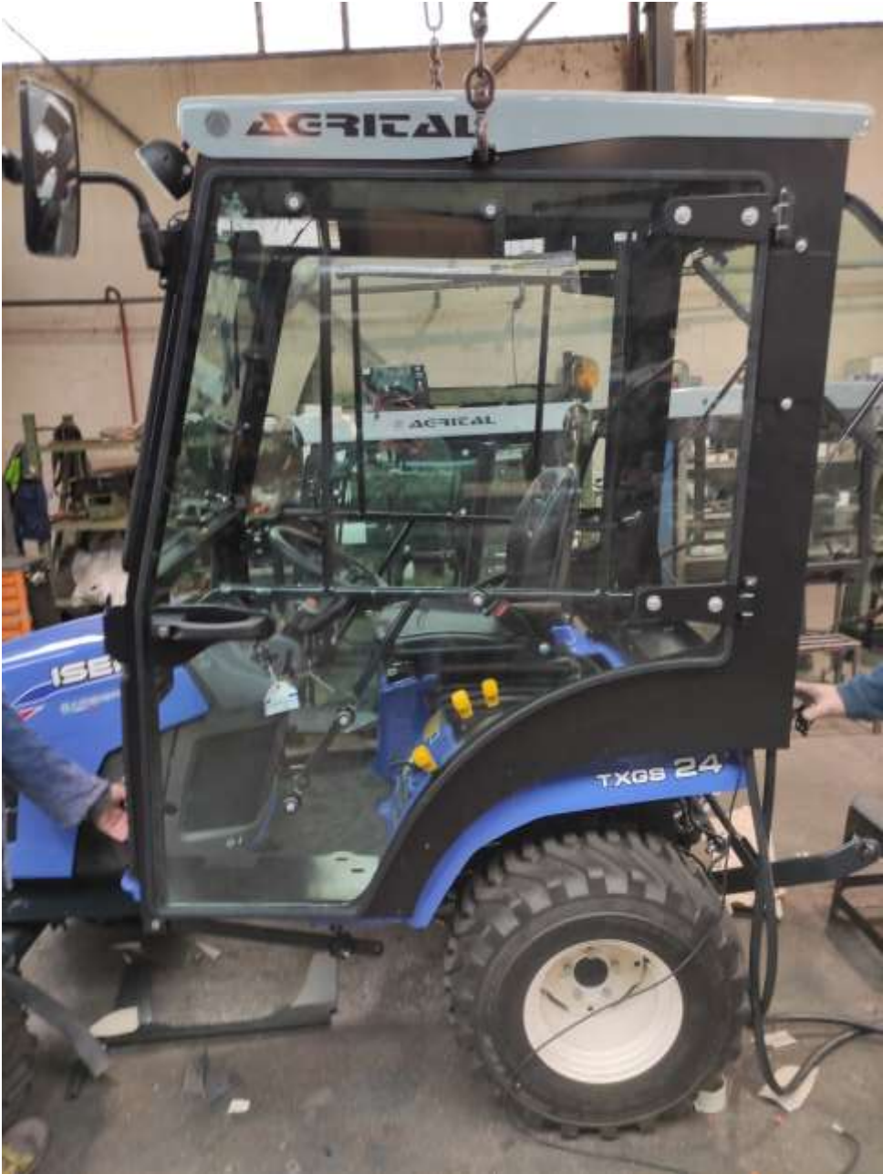
Fissaggio struttura cabina
