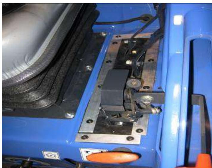
Sopra all' interno della cabina utilizzare la gomma telata e le barre di alluminio con auto-forant
