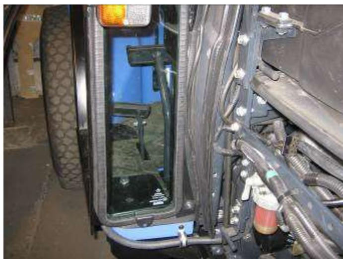
Foto per lamiera di chiusura per girocofano inferiore da inserire all' esterno o all' interno dell' abitacolo, sia a destra sia a sx.
