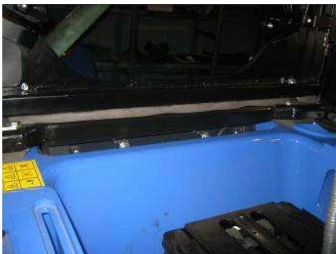
Foto per guarnizione tra trav posteriore e panca
