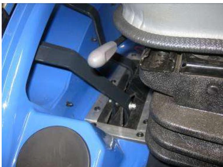
Togliere il sedile e procedere incollando il rivestimento posteriore e parafanghi (unico) e sottosedile:
