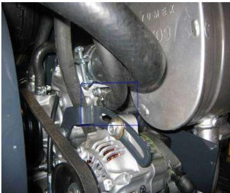
INSERIRE il tubo di RITORNO che esce predisposto dalla cabina al raccordo ORIGINALE che si trova nella parte in alto del vano motore. ( vedi foto sotto per individuare il raccordo).
