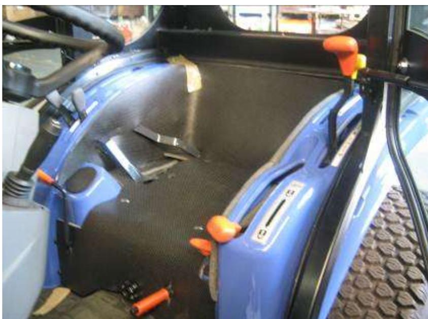
Inserire e poi bloccare con viti autoforanti le lamiere, provviste di guarnizione, sotto il cruscotto sia a destra sia a sinistra.
