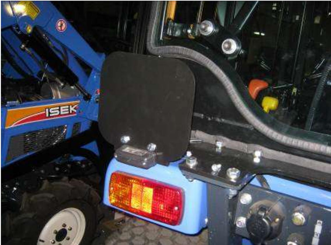
Foto per portatarga (da collegare e rimontare la luce)
