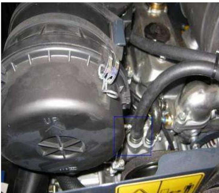
I tubi del riscaldamento vanno protetti col tubo in plastica fornito (per il tratto scoperto fra cabina e vano motore).
