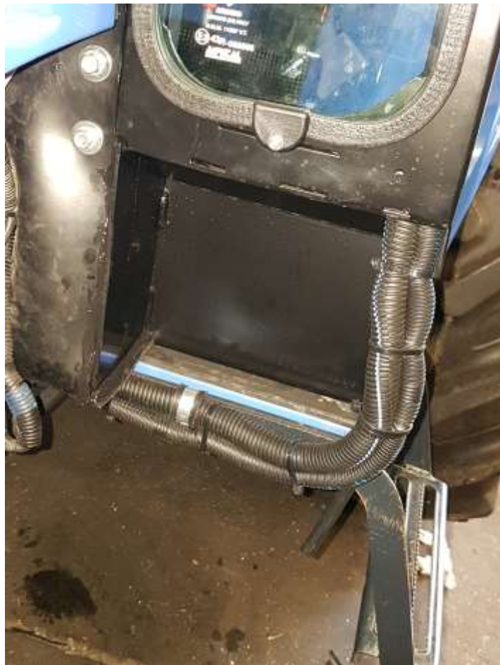
POSA CAVI ELETTRICI PER RISCALDAMENTO
