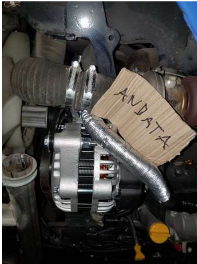
POSA TUBO MANDATA RISCALDAMENTO
