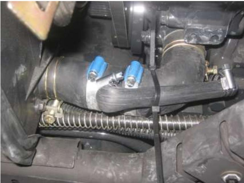
I tubi del riscaldamento vanno protetti col tubo in plastica fornito (per il tratto scoperto fra cabina e vano motore).
