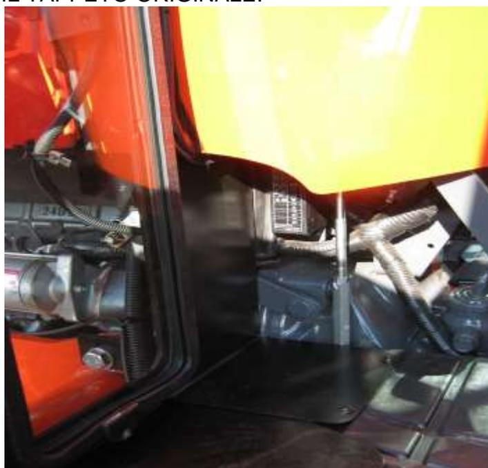
Senza pala l'oblò dx è avvitato e simmetrico al sx (invece saldato)
