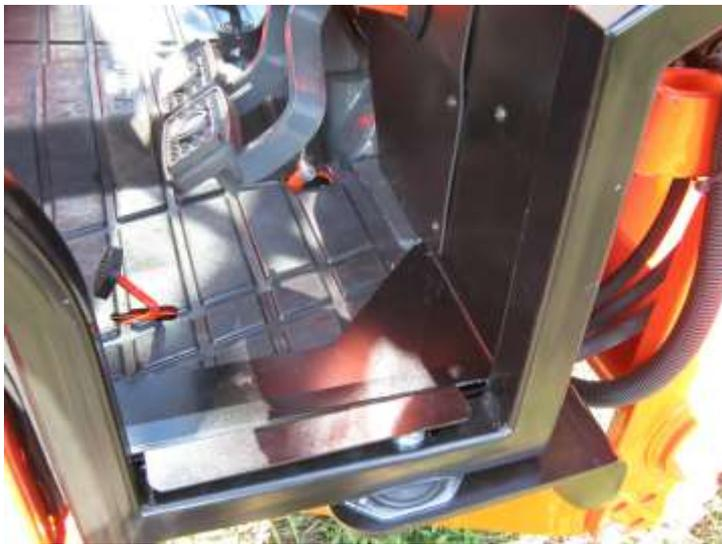
Inserire la chiusura del girocofano all' interno e fissare con autoforanti
