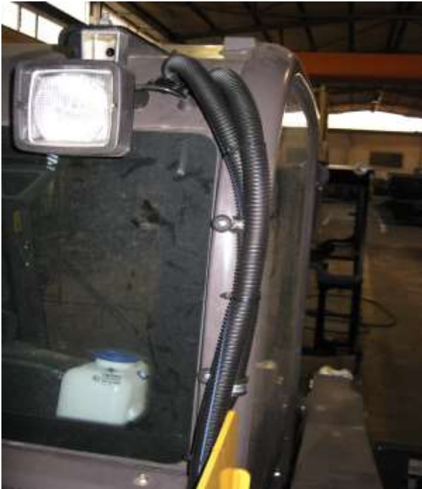
TUBI DEL RISCALDAMENTO USCENTI DALLA CABINA.
